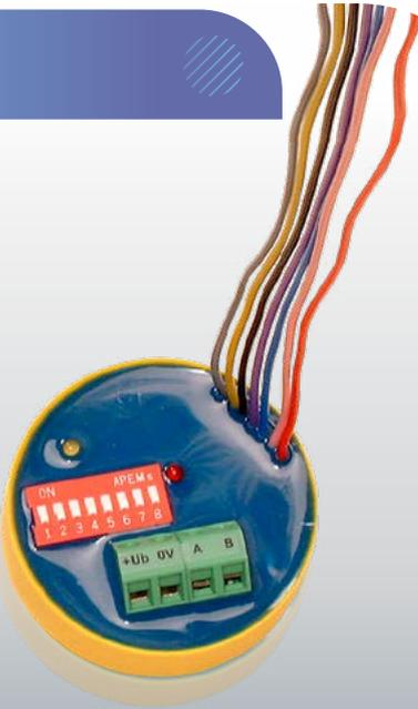
UP-I/O-Modul zur Ankopplung von Fremdgeräten wie z.B. Bewegungswächter mit einer Betriebsspannung von 5V an das Subnet. Die geregelte Betriebsspannung von +5V wird geregelt vom I/O-Modul zur Verfügung gestellt. Mit dem Modul können 2 Befehle an das BUS-System übergeben und 2 Meldungen ausgegeben werden.
