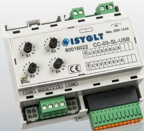
Der Compact-Controller slim line ist speziell für kleine und einfache Steuerungsaufgaben geeignet. Seitens der Hardware sind ein Relaisausgang in Hybridtechnik, 4 Potentiometer, 8 Kleinspannungstastenanschlüsse und 8 Kleinspannungsrückmeldungen vorhanden. Mit diesen Voraussetzungen ist eine Vielzahl von Kleinsteuerungen realisierbar. Der ISYGLT-Controller ist frei programmierbar und mit den verfügbaren ISYGLT-BUS-Komponenten erweiterbar.
