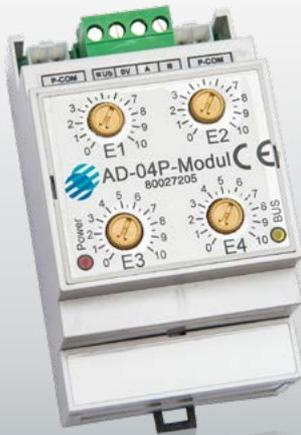
Poti-Modul zur Eingabe von 4 Sollwerten mit einem Wertebereich von 0-100% (0-255). Die Einstellung der Sollwerte erfolgt je Kanal über ein separates, im Modul integriertes Potentiometer.
