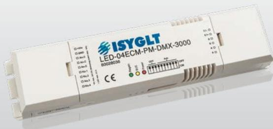
Professioneller LED-Dimmer – auch LED-Konverter, LED-Treiber oder LED-Driver genannt – zur Steuerung von LEDs mit Vorschaltel Elektronik für Spannungsanschluss, per DMX oder ISYGLT. Die Adresse wird bei ISYGLT oder DMX über DIP-Schalter eingestellt.
