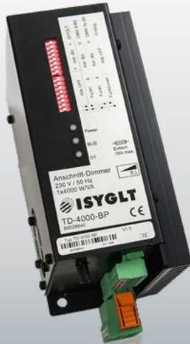
Phasenanschnittdimmer 4000W in 16Bit „Thyristor Antiparallel Technologie“ für alle ohmschen Lasten (Glühlampen, Hochvolthalogen, Heizungen) und induktiven Verbraucher (Halogen mit magnetischen Trafos, Leuchtstofflampen mit VIP-90, Motore, Kunststoffschweißgeräte mit magnetischen Trafo).
