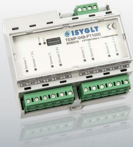
Analoges Temperatur-Modul mit 4 Eingängen. An jedem Eingang kann ein PT1000-Sensor wahlweise in 2-Leiter- oder 3-Leiter-Technik betrieben werden. Der Unterschied zwischen den beiden Varianten liegt in der Genauigkeit der Auswertung. Bei der 3-Leiter-Technik wird der Fühler automatisch kompensiert. Somit ist die Leitungslänge für ein exaktes Ergebnis nicht entscheidend.
