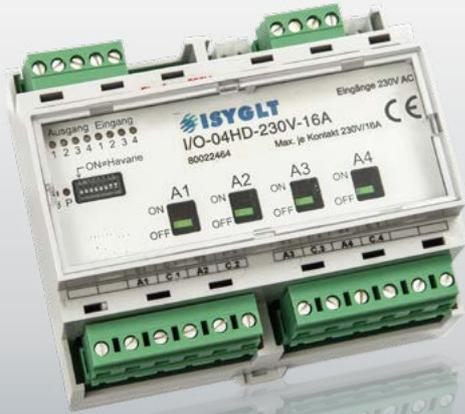
I/O-Modul mit 4 Optokopplereingängen und 4 Relaisausgängen mit Hand-Bedienmöglichkeit. Alle Ein- und Ausgänge sind in den Funktionen frei und unabhängig voneinander programmierbar. Zusätzlich stehen umfangreiche Havarie- und Logikfunktionen zur Verfügung. Die Ausgangsrelais bleiben auch bei Spannungsausfall in der letzten Stellung. Es steht eine Variante mit Kleinspannungseingängen (I/O-04H-230V-16A), und eine Variante mit 230V AC-Eingängen (I/O-04HD-230V-16A) zur Auswahl.
