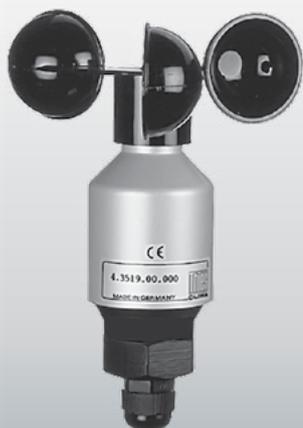
Windgeber der Spitzenklasse zur Erfassung der horizontalen Windgeschwindigkeit 0,5 bis 50m/s. Für den Winterbetrieb ist der Geber mit einer elektronisch geregelten Heizung versehen, um das Einfrieren der Kugellager und der äußeren Rotationsteile zu verhindern.
