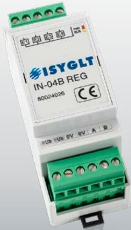
Das IN-Modul dient zum Anschluss von konventionellen Drucktasten und Schaltern an das Subnet. Mit diesem Modul können 4 Befehle an das BUS-System übergeben werden. Der Anschluss der Tasten/Schalter erfolgt mittels Anschlussklemmen.
